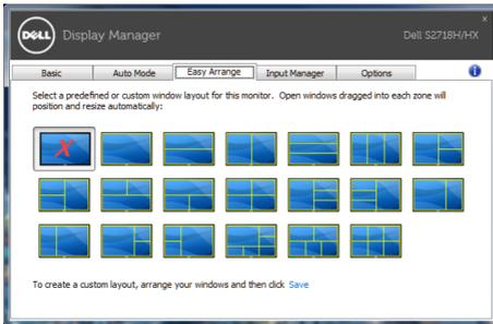
如要创建自定义的窗口布局，请先在桌面上确定最多10个窗口的尺寸和位置，然后单击**Easy Arrange（简单排列）**中的**Save（保存）**链接。这些窗口的尺寸和位置另存为一个自定义的布局，并为该自定义布局创建一个图标。
